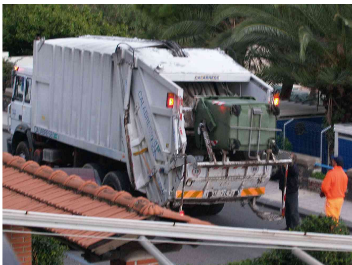
イタリアのゴミ収集システム。機械力を使い大型収集容器を取り込む。
